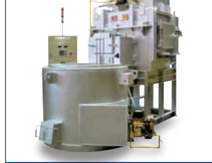
異種合金対応AL連続溶解保持炉 モーレックスアルイッシュ MOREX AL-ISSHU
