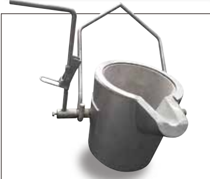
取鍋・プレキャスト施工 LADLE & PRECAST CONSTRUCTION
